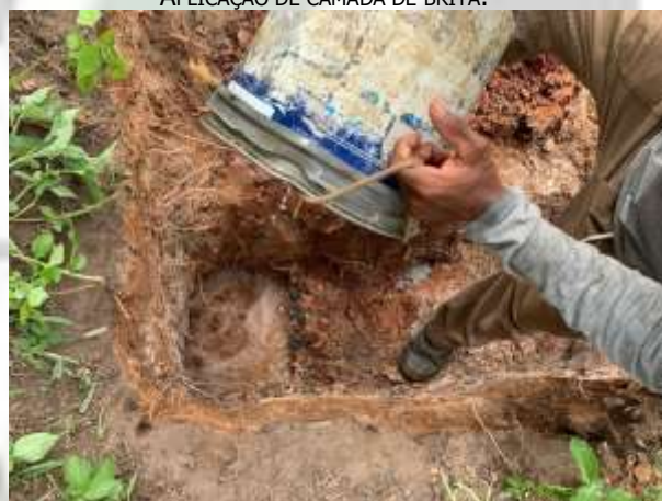
FOTO 10 SATURAÇÃO DE JANELINHA, APÓS APLICAÇÃO DE CAMADA DE BRITA.
