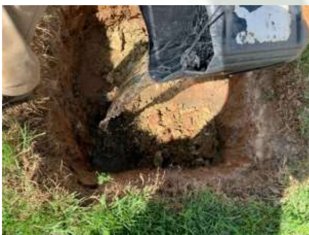
FOTO 11 SATURAÇÃO DE JANELINHA, APÓS APLICAÇÃO DE CAMADA DE BRITA.
